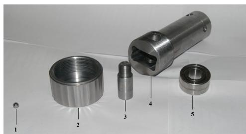
Рис. 2. Устройство для накатки: 1 – шарик  $\varnothing$  6 мм; 2 – опорная крышка; 3 – осевой палец; 4 – корпус; 5 – роликовый подшипник
