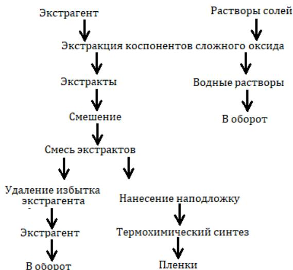
Рис. Схема экстракционно-пиролитической технологии
