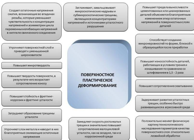
Рис. 2. Достоинства поверхностного пластического деформирования
