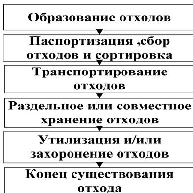
Рис. 1. Принципиальная схема жизненного цикла отходов
