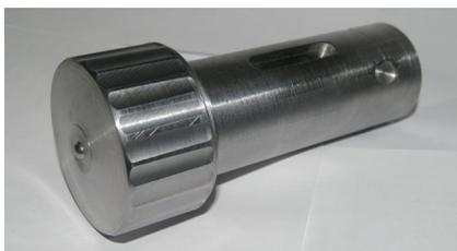
Рис. 1. Устройство для накатки в сборе
