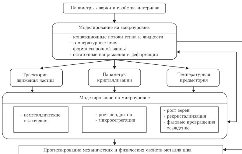
Рис. Схема моделирования структуры металла сварного шва
