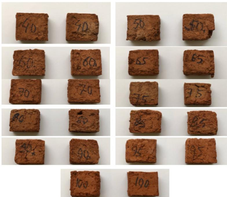
Рис. Образцы керамических изделий с использованием ОПТ НСО
