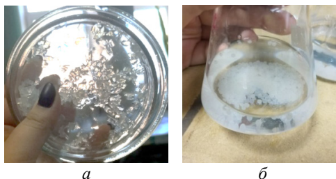
Рис. 1. Биокатализаторы на основе агарозного (а) и альгинатного (б) гелей
