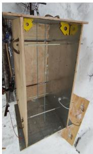
Рис. 1. Устройство для уплотнения снега в боре
