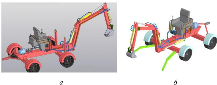
Рис. 3. Компоновка малогабаритного экскаватора с рабочим оборудованием в транспортном (а) и рабочем состоянии опор (б)
