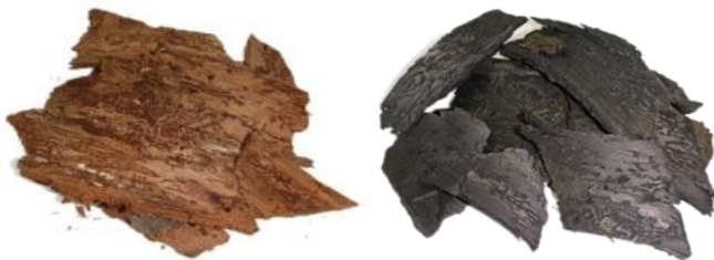
Рис. Образцы коры, поврежденной уссурийским полиграфом до и после пиролиза
