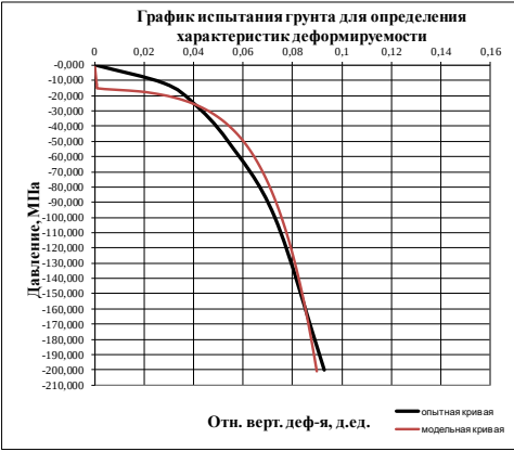
Рис. 1. Зависимость относительной вертикальной деформации от давления для суглинка мягкопластичного
