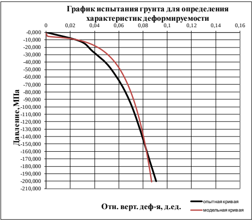
Рис. 2. Зависимость относительной вертикальной деформации от давления для суглинка текучепластичного
